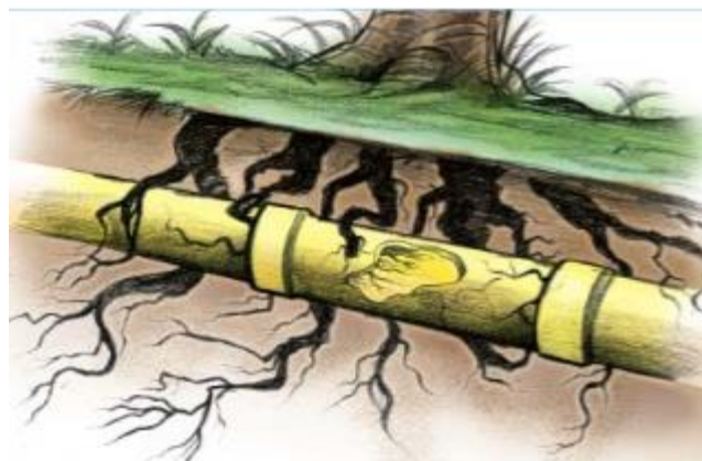
Figura 5: interferências causada por árvores no subsolo.
